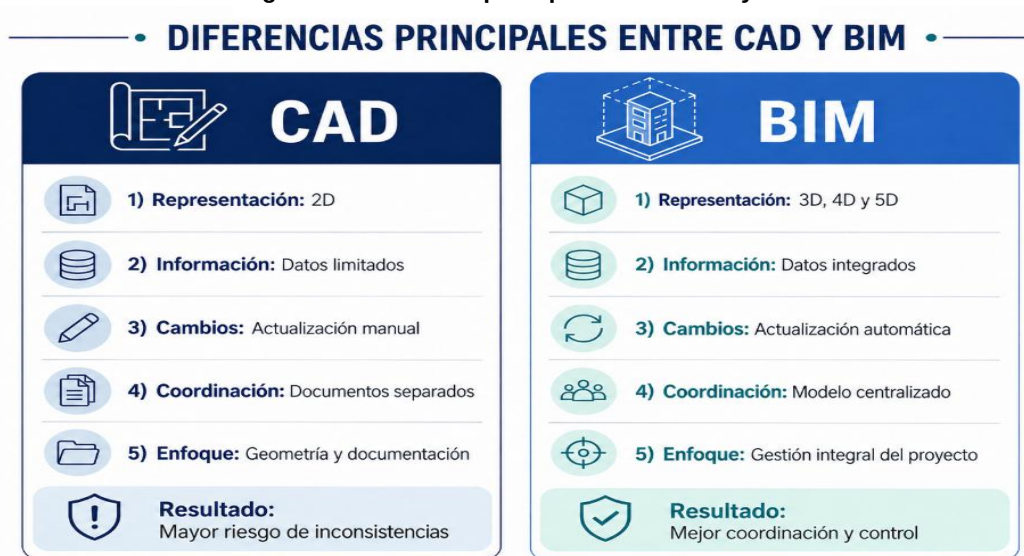
Figura 5. Diferencias principales entre CAD y BIM.
