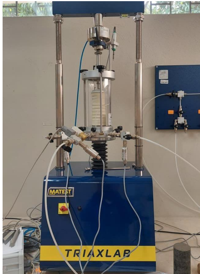
Ilustración 22. Equipo de ensayo triaxial empleado para la caracterización mecánica de mezclas BSM.
