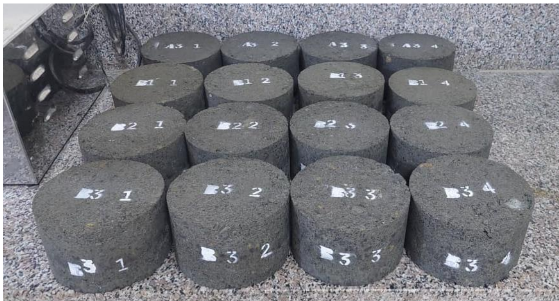
Ilustración 17. Probetas elaboradas con las diferentes dosificaciones de cal y emulsión asfáltica para el diseño de la mezcla BSM. Fuente: Autor.
