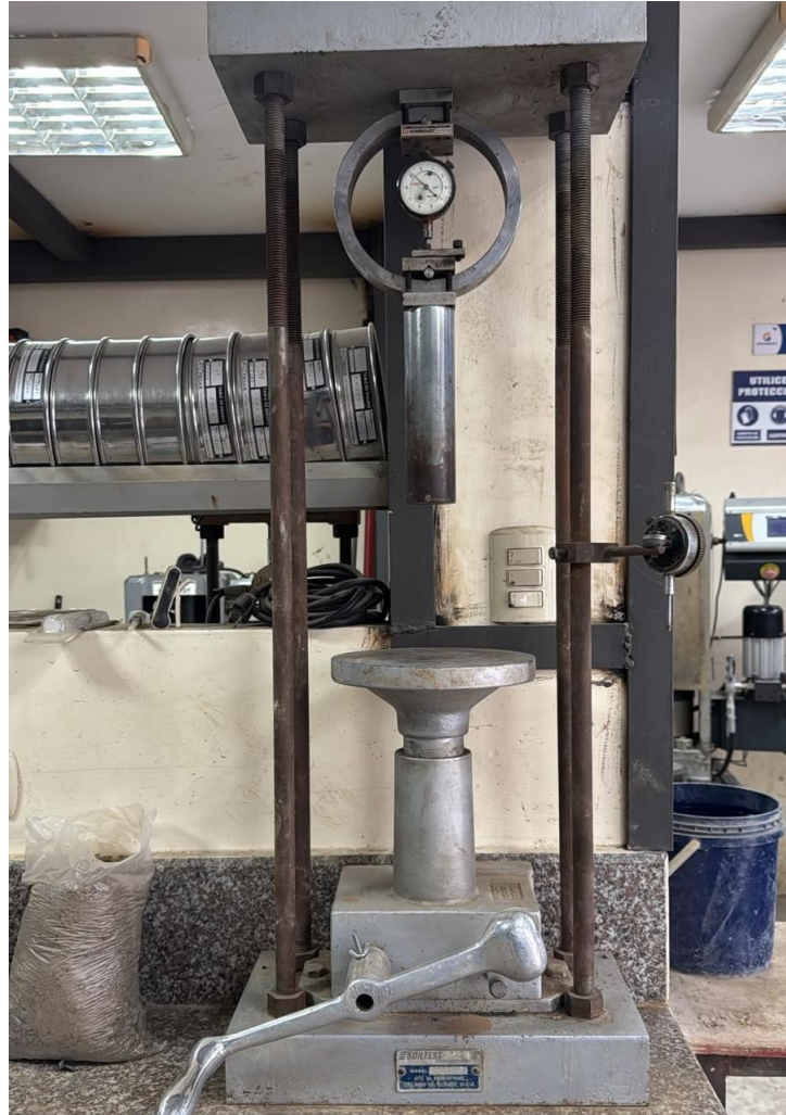
Ilustración 16. Equipo utilizado para la ejecución del ensayo CBR en laboratorio. Fuente: Autor.
