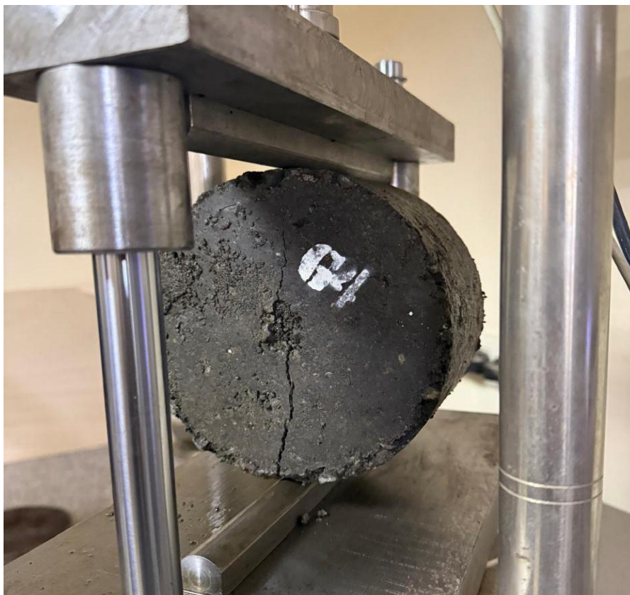
Ilustración 20. Probeta cilíndrica de mezcla BSM durante la ejecución del ensayo de resistencia a la tracción indirecta (ITS). Fuente: Autor.
