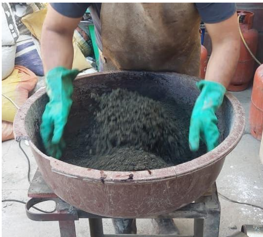
Ilustración 18. Proceso de mezclado y homogeneización manual del material granular posterior a la incorporación de cal y emulsión asfáltica. Fuente: Autor.
