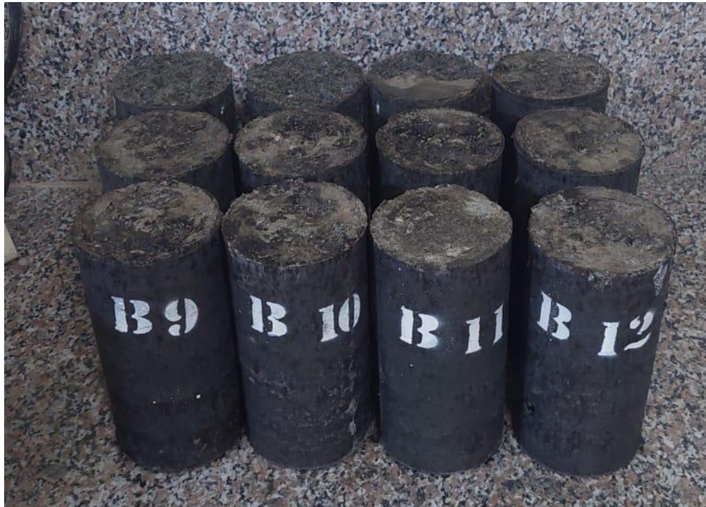
Ilustración 21. Probetas cilíndricas de mezcla BSM compactadas en laboratorio, debidamente identificadas y preparadas para la ejecución de ensayos triaxiales. Fuente: Autor.
