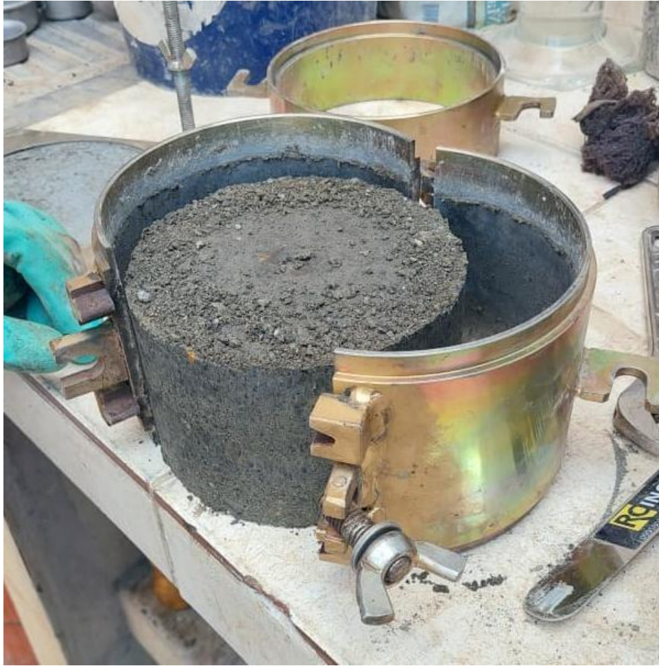
Ilustración 19. Probeta de mezcla BSM compactada en molde cilíndrico, previo al proceso de desmoldeo y curado. Fuente: Autor.
