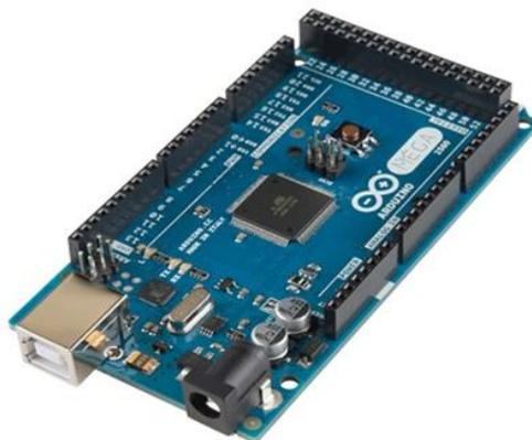
Figura 2. 11: Tarjeta Arduino Mega.
