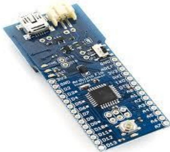
Figura 2. 14: Tarjeta Arduino Fio.
