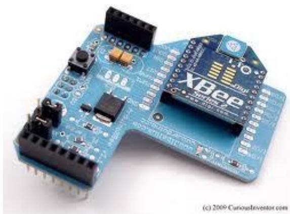
Figura 2. 19: Módulo de comunicación Xbee de Arduino.
