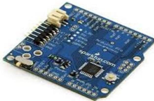
Figura 2. 16: Tarjeta Arduino Pro.
