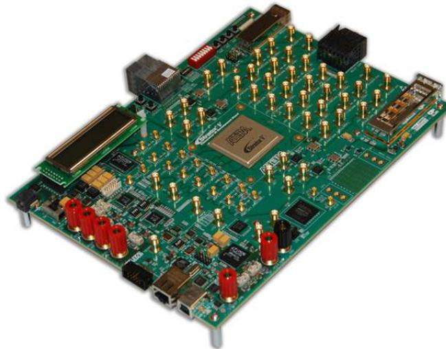
Figura 3. 5: Tarjeta Stratix IV GX de Altera.
