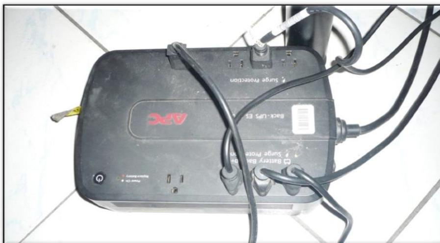
*Figura 3.22 UPS portátil para protección de computadoras*
