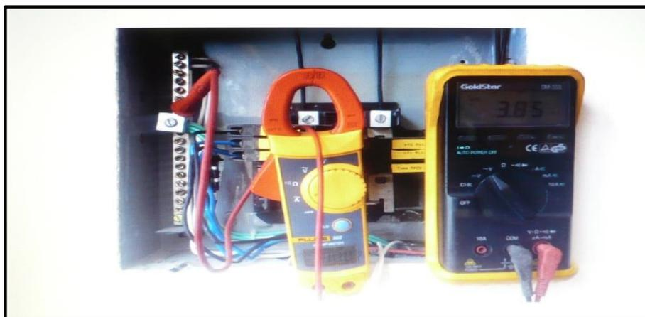
*Figura 3.27 la lectura de la barra del neutro en laboratorio de telecomunicaciones*
