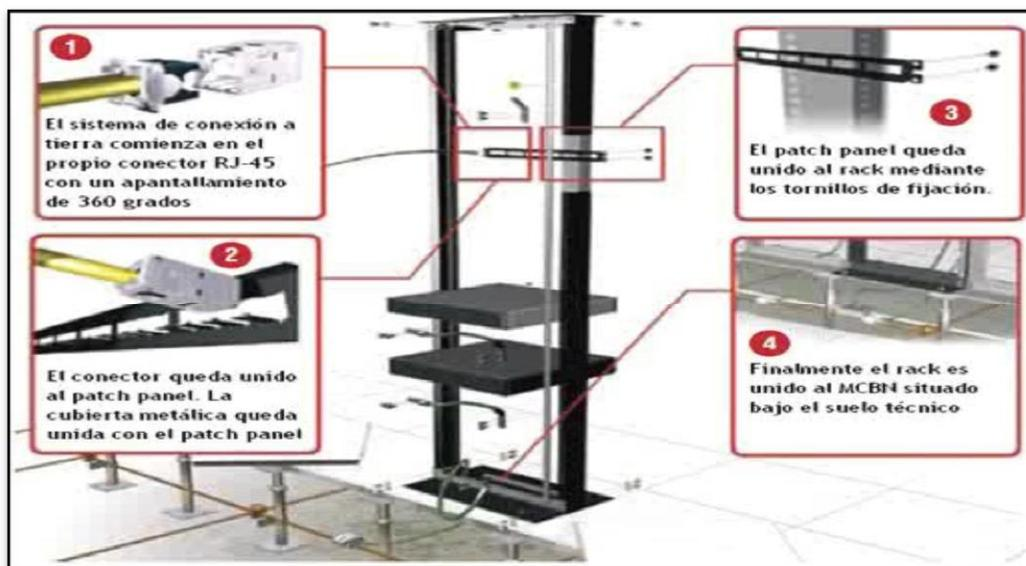
Figura 2.13 Aterramiento de Redes en los Bastidores
