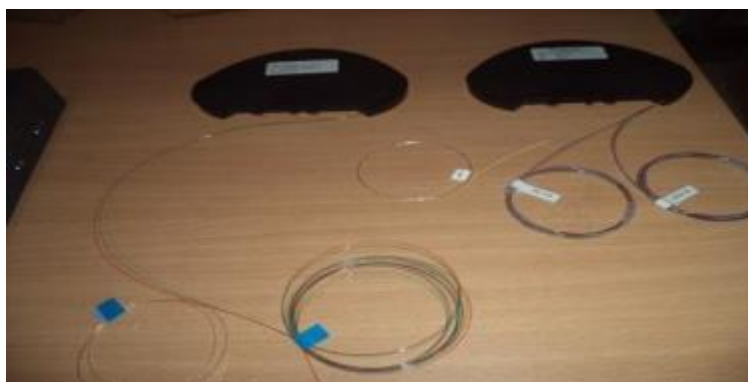
Figura 4.7: Splitter tipo cassette para mangas Fuente: (Lorenti, 2014)
