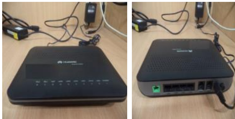
Figura 4.5: ONT Huawei Echolife H685oa Fuente: (Lorenti, 2014)
