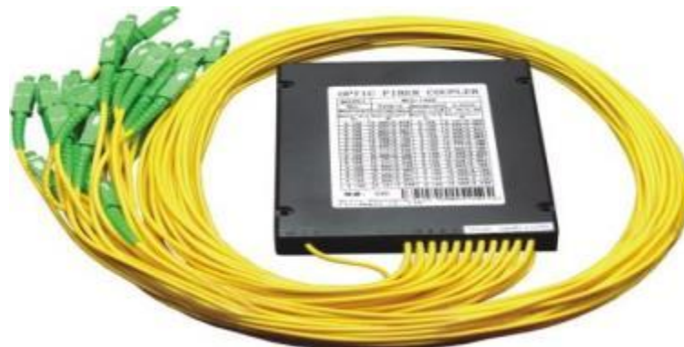
Figura 4.6: Splitter tipo ODF una entrada varias salidas Fuente: (Espol, 2013)
