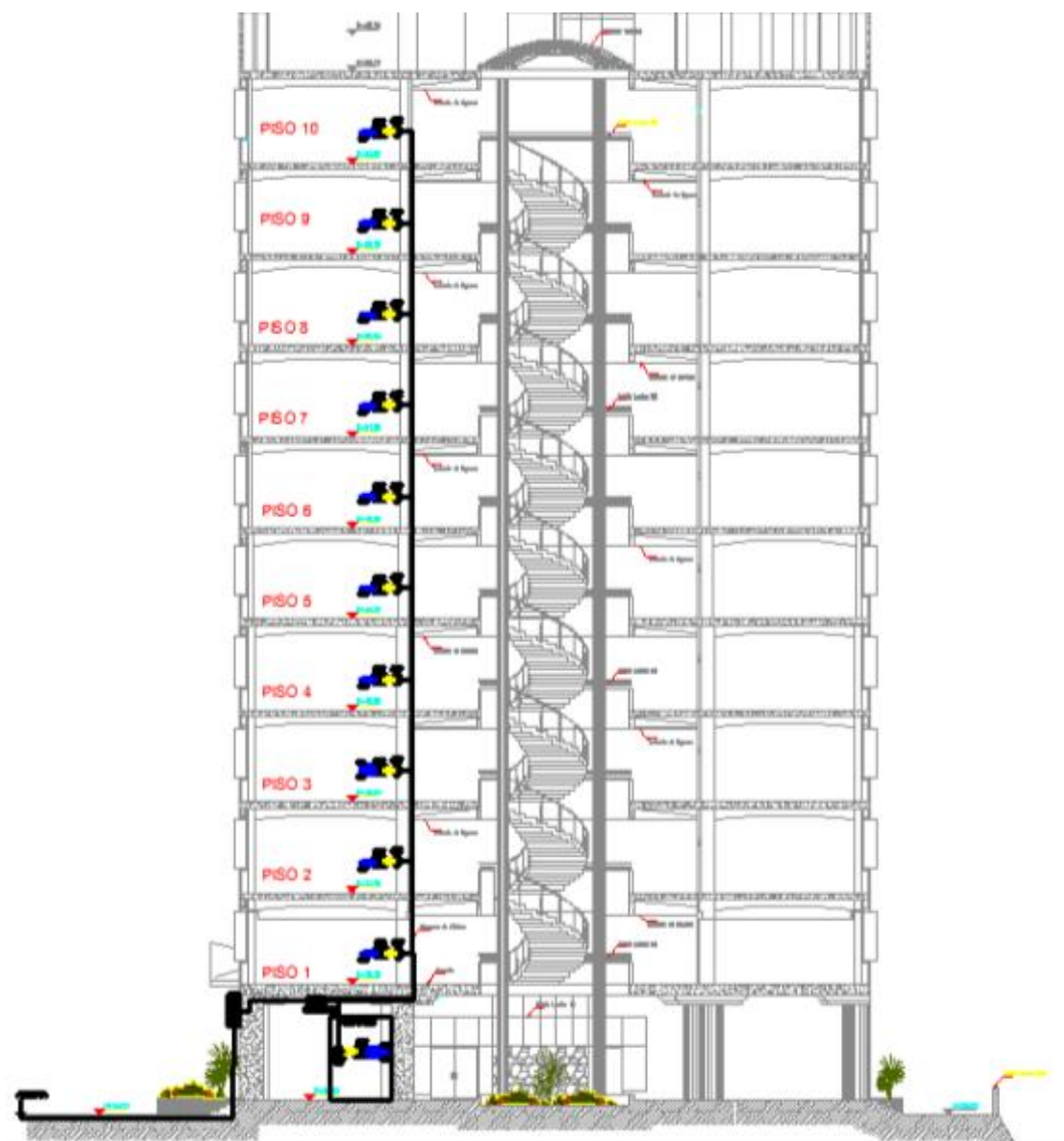
Figura 7.6: Diagrama de la ubicación de los splitter y ONTs en el edificio Fuente: (Lorenti, 2014)
