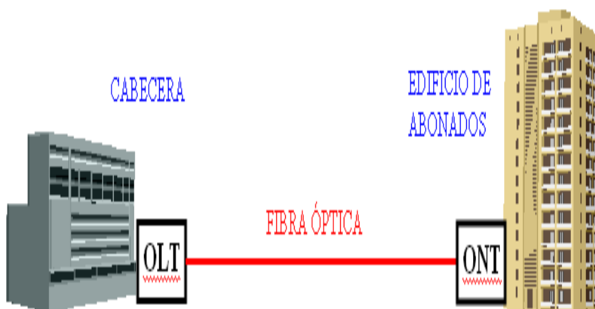
Figura 3.4: Elementos básicos de la arquitectura FTTB Fuente: (Gonzalez Velasco Jorge Antonio, 2009)
