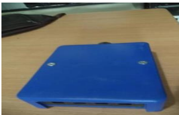
Figura 2.17: ODF de 4 puertos Fuente: (Lorenti, 2014)
