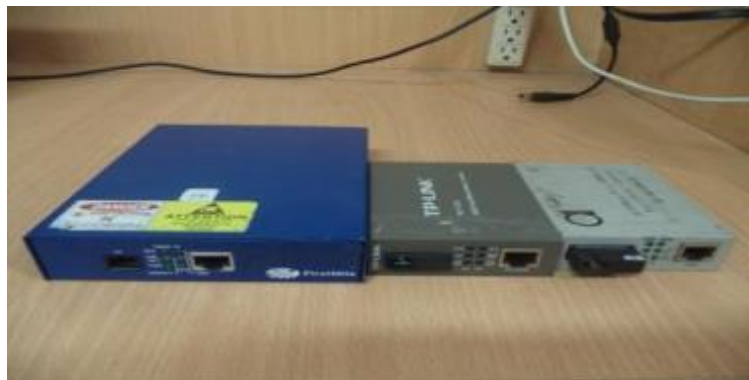
Figura 2.5: Conversores de fibra óptica Fuente: (Lorenti, 2014)
