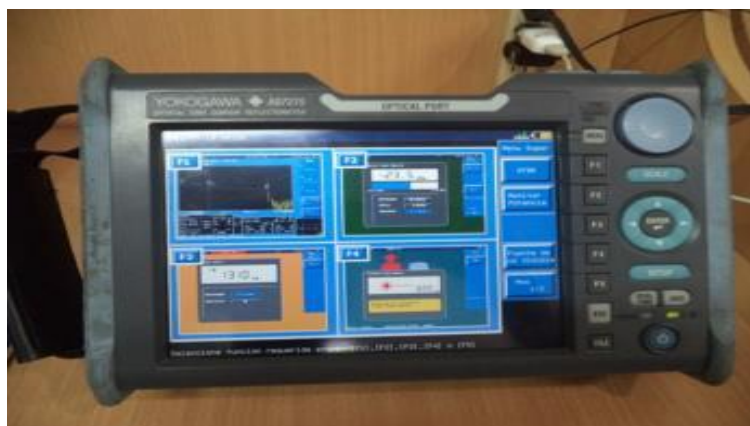
Figura 2.24: OTDR Yokogawa- AQ 7275 Optical Port Fuente: (Lorenti, 2014)
