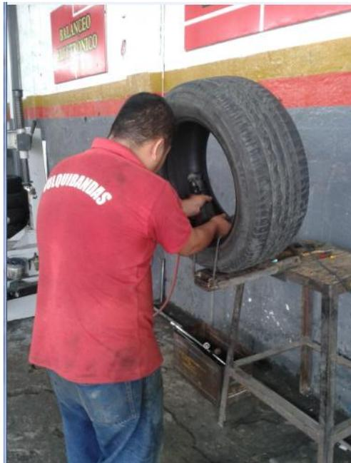
FIGURA 5. ILUSTRACIÓN DE VULCANIZACIÓN DE LLANTAS
