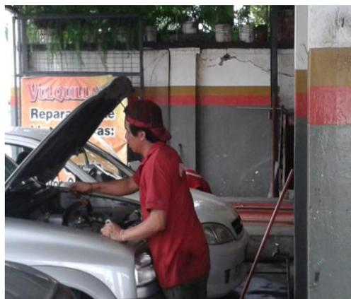
**Figura 10. LIMPIEZA DE INYECTORES**
