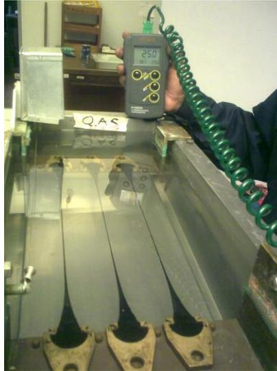
**Gráfica 3-1. Ensayo ASTM D113 de ductilidad, en el cemento asfáltico. Fuente: <http://www.abc.gob.bo/Ensayos>**
