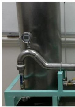
Figura # 53 Ubicación del transmisor de presión en el prototipo.
