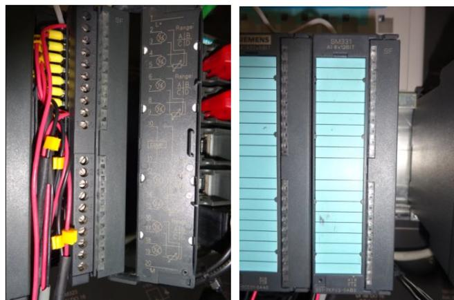
**Figura # 61 Módulo de entrada analógica 4-20mA SM331.**
