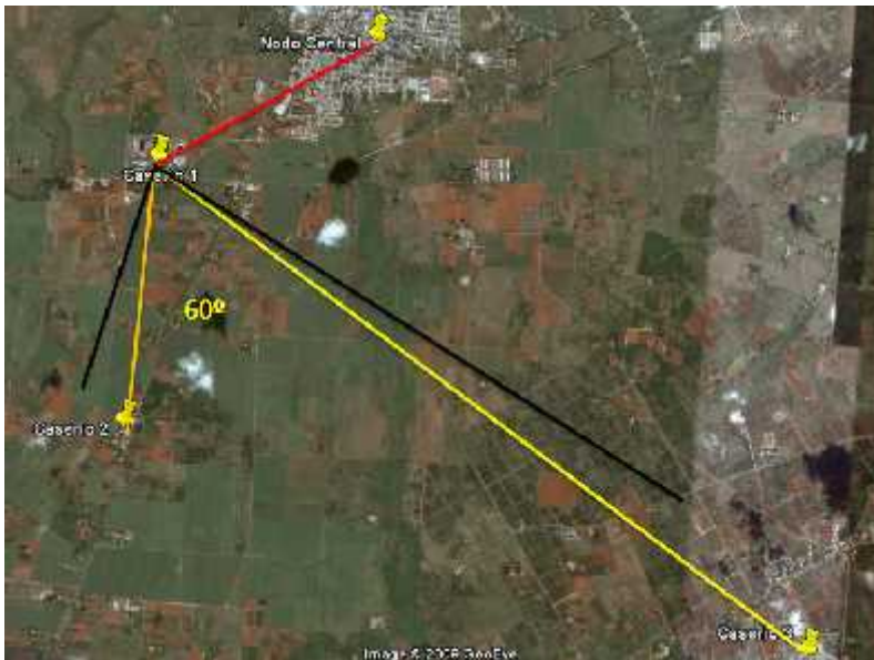
Figura 3. 18 Topología punto a punto y punto multipunto. Fuente: Imágenes tomadas de Google Earth
