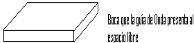
**Figura 2.1.** Guía de onda como antena.
