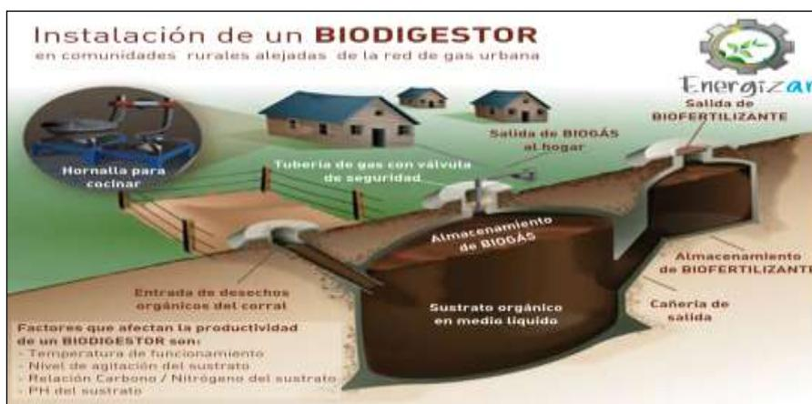
**Ilustración 50:** Esquema básico de un biodigestor y del inicio de la conducción de biogás hacia la cocina.
