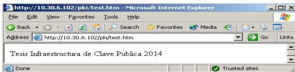
Figura 2. 7 Comprobación del funcionamiento del directorio virtual de IIS
