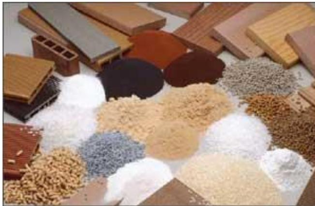
**Figura 75: Materiales utilizados para el WPC**
