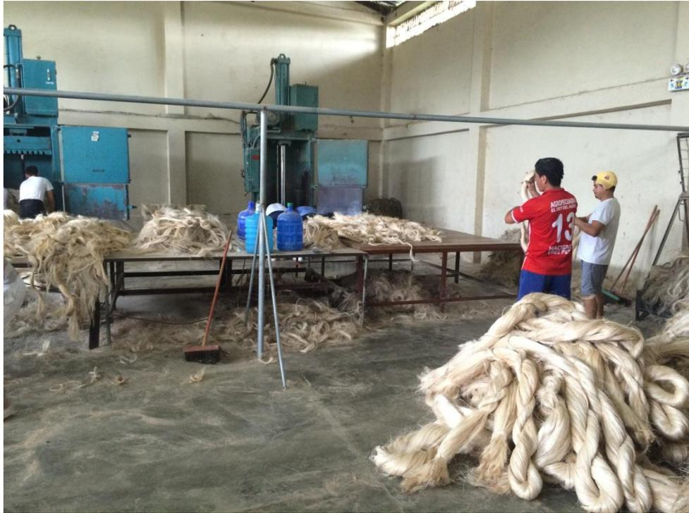
PROCESO DE TRENZADO, INSPECCION Y PRENSADO DE FIBRA DE ABACÁ.
