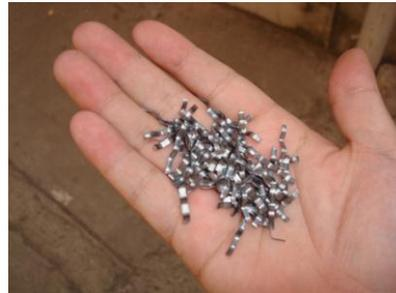
Fig. 6.8 Fibras de Acero<sup>5</sup>, longitud de 30 mm, diámetro de 1,10 mm y espesor entre 0,5 – 1,0 mm
