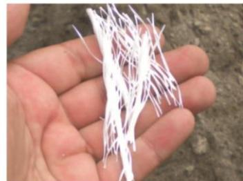
Fig. 6.7 Polipropileno PP<sup>4</sup>
