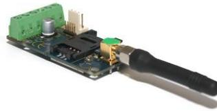
*Figura 2-6. Módulo GSM*
