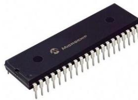
*Figura 2-1. Microcontrolador PIC 16F4550*
