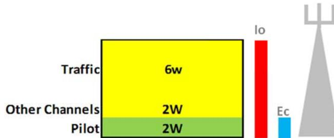
Figura 3. 18 Cálculo de  $E_c/I_o$  con carga de tráfico.
