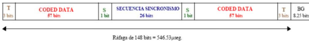
**Figura 2. 6 Estructura de una ráfaga normal**
