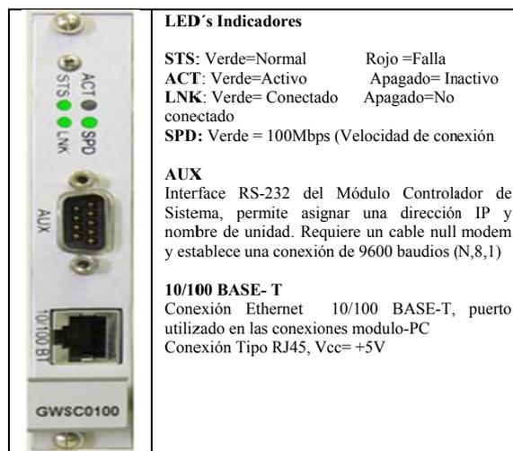
**Figura 3. 3 Módulo de Control del Sistema**
