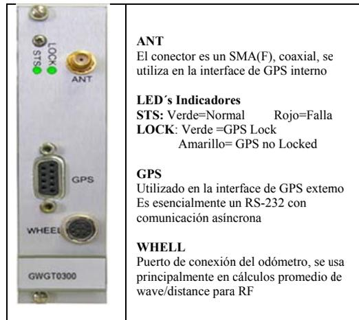
**Figura 3. 4 Módulo GPS/Timebase**
