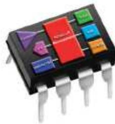
Figura 2. 22: Microcontrolador PIC de 8 pines.
