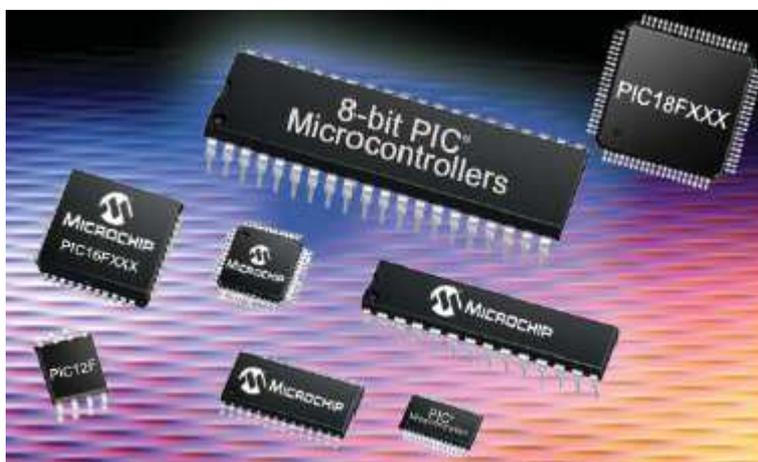
Figura 2. 18: Dispositivos PIC de 8 bits.
