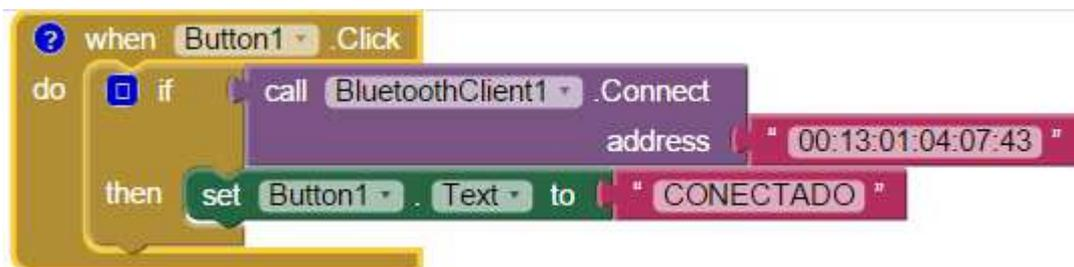
Figura 3. 12: Programación para el enlace entre celular y sensor.
