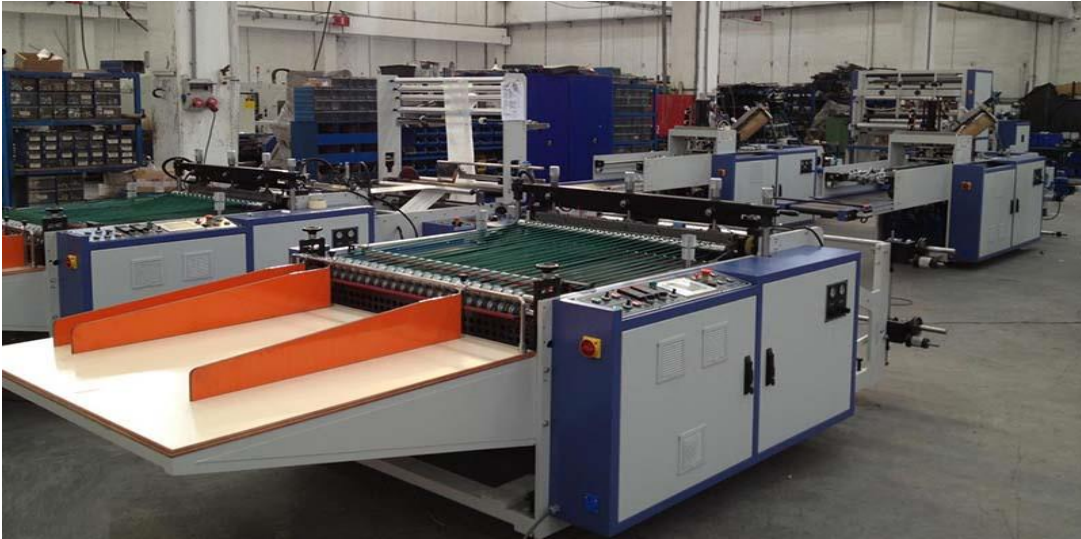
Imagen 10.- Máquina selladora o convertidora instalada en la planta de producción.
