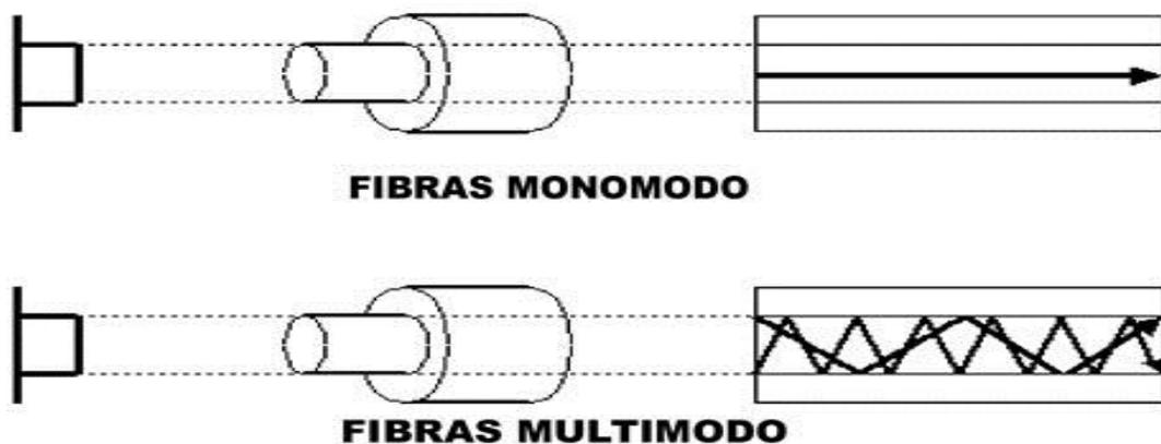
*Figura 4. 4: Tipos de fibra óptica*
