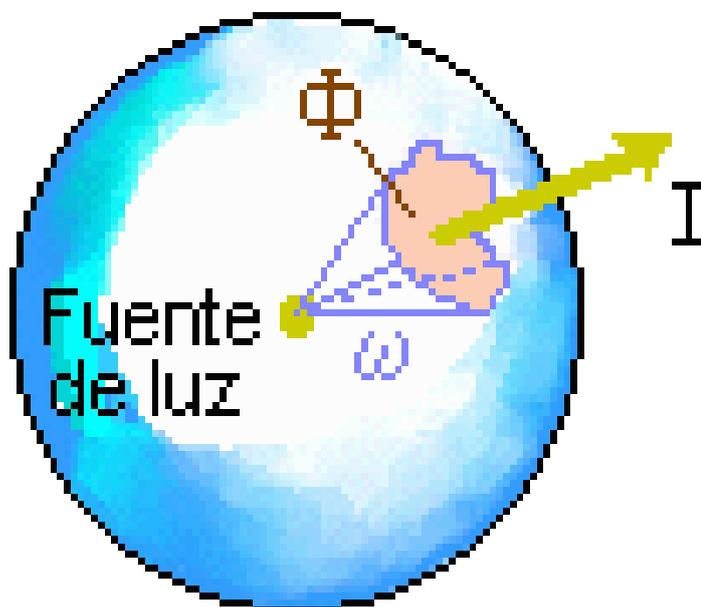
**Figura 2.6** Intensidad Luminosa emitida por una fuente de luz
