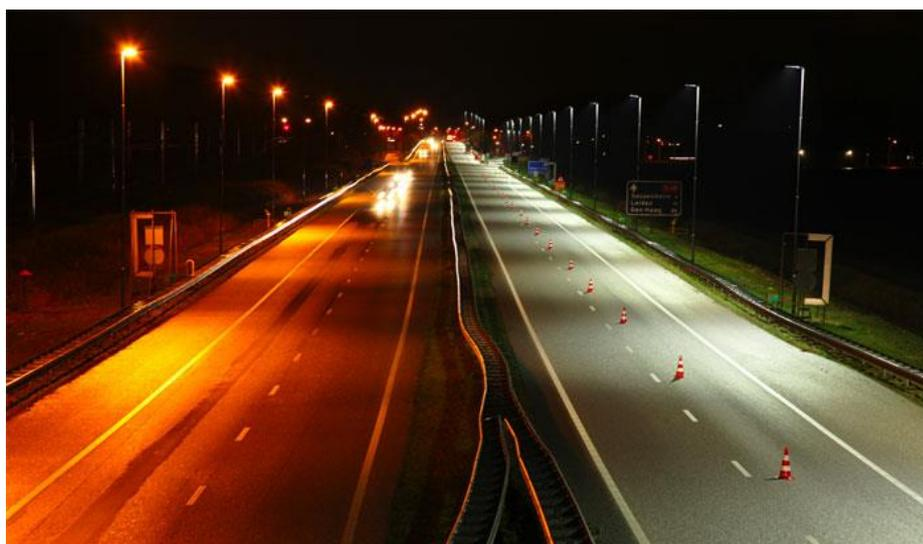
**Figura 4.7 Mejor calidad de iluminación mediante lámparas LED a 120W (lado derecho) vs lámparas de Sodio a 250W (lado izquierdo)**
