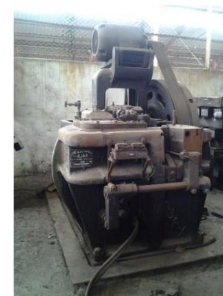
Figura 52: Maquinaria para fabricar tornillos.
