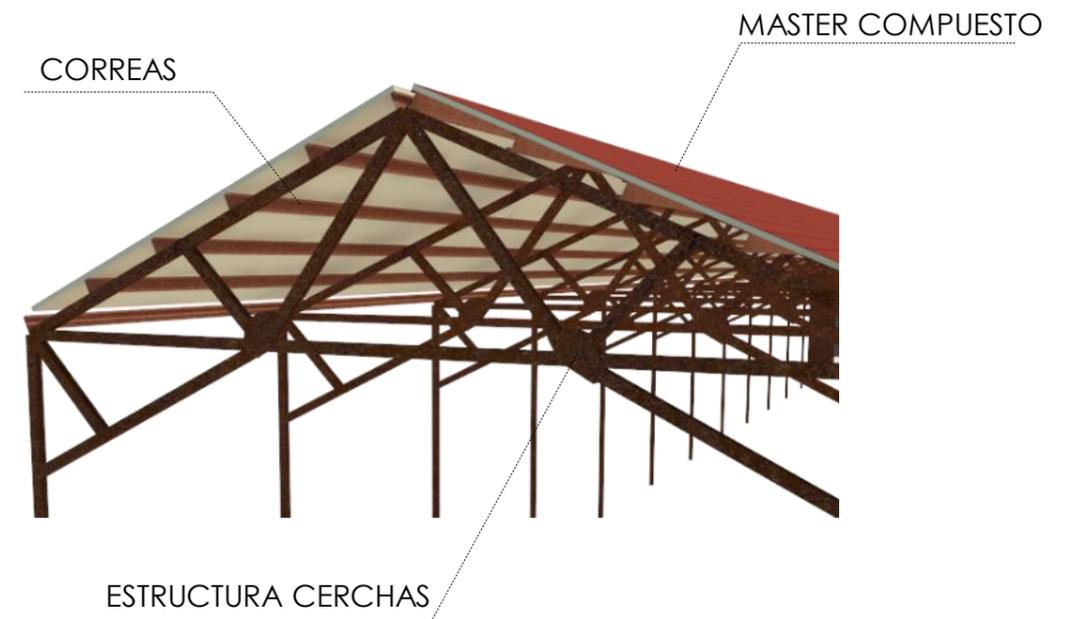
Figura 107: Detalle de cubierta. Fuente: Ambrosi (2015)
