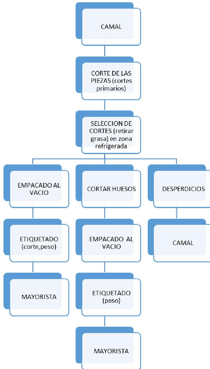
**Figura 8. Diagrama de flujo empaçado al vacío**
