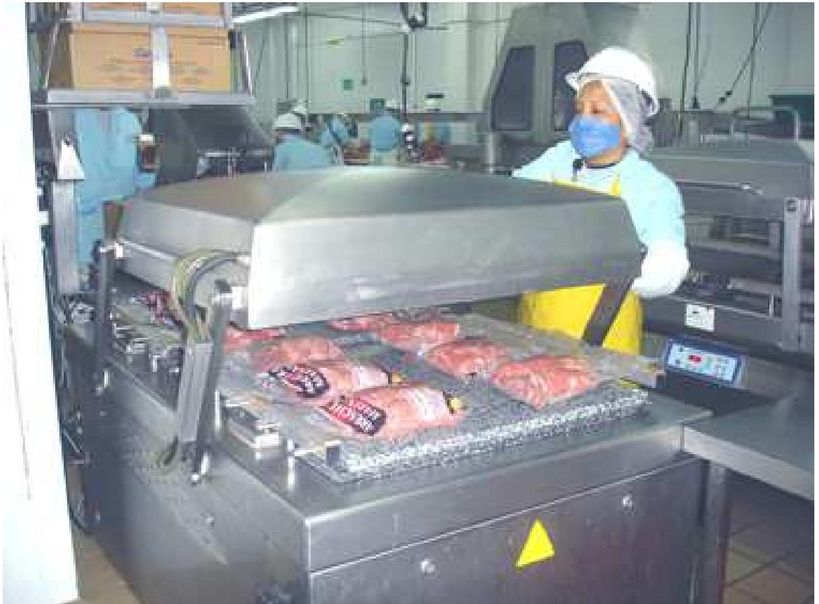
**Figura 19. Empacando al vacío, maquina industrial**
