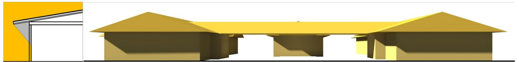
**Figura 13:** Asoleamiento directo en ángulo de 50 grados vertical de la fachada Sur del actual edificio municipal de Puerto Villamil
