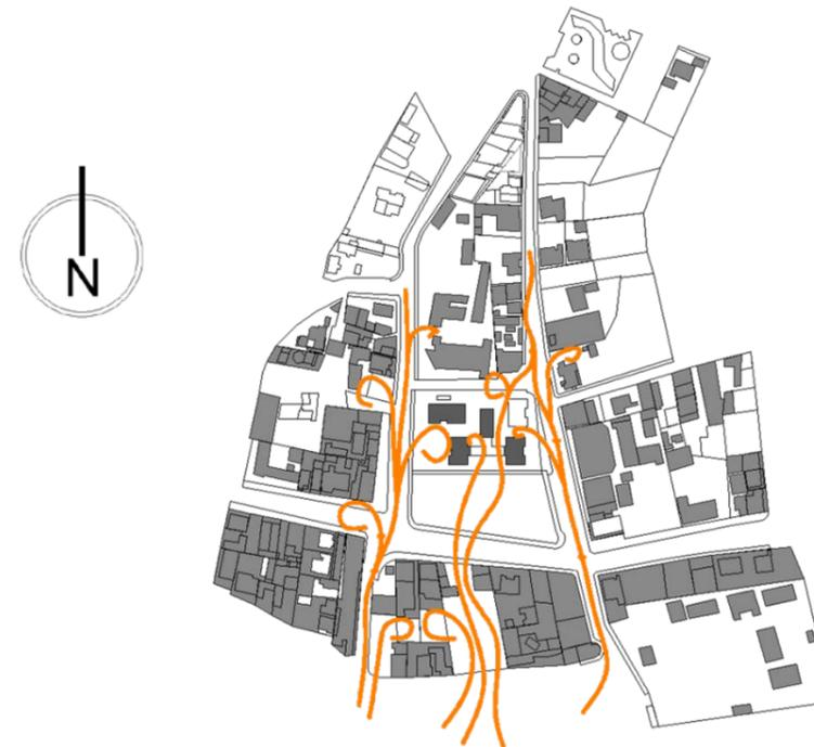
**Figura 16:** Masas de aire en movimiento por diferencia de temperatura
