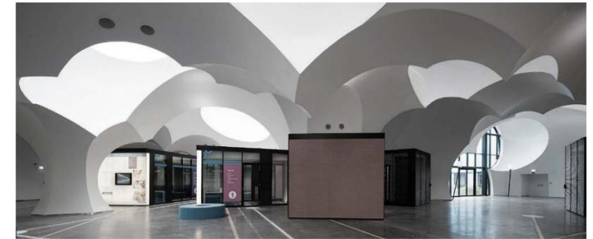
**Figura 52:** Ayuntamiento - Cielo raso construido a base de encofrados inflables los cuales donan la apariencia de nubes.
