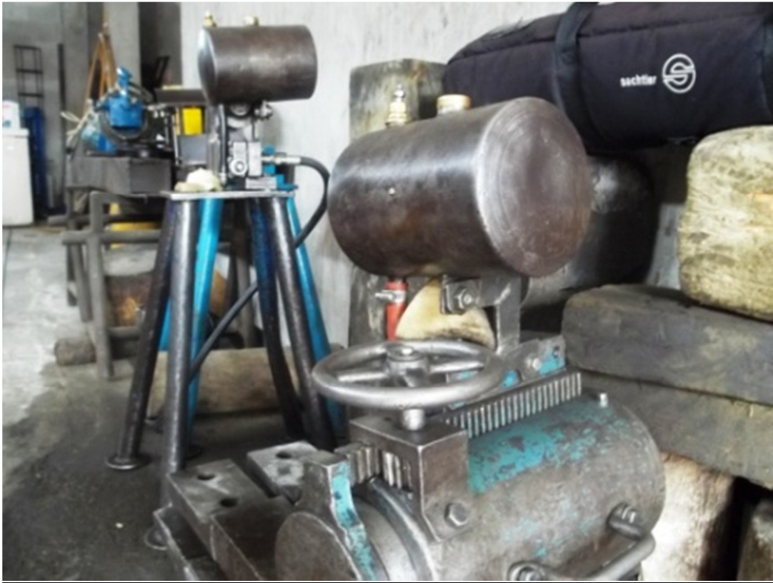
Figura 14. Prensas hidráulicas del Maestro Davis. (Pedro Villegas, 2012)
