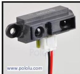
Figura 3. 10: Sensores infrarrojos de distancia SHARP 2Y0A21.
