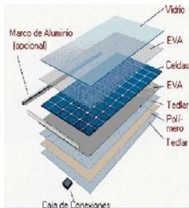
Figura 4. 4 *Cubierta posterior.*
