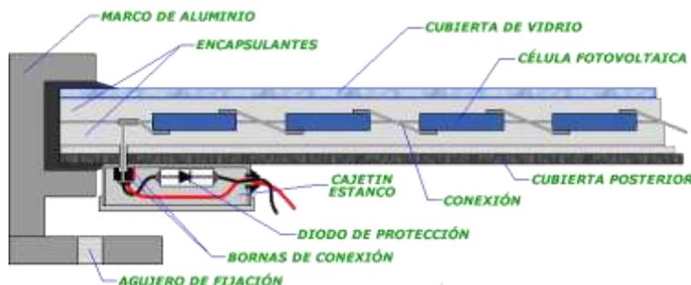
Figura 4. 7 *Diodo de protección.*
