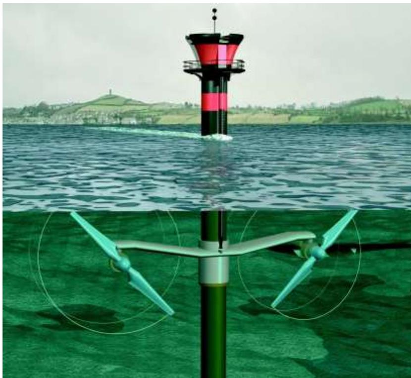
Figura 2. 5 *Diseño de una torre mareomotriz.*
