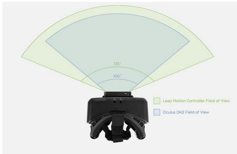
**Ilustración 39.** Rango de acción del Leap Motion
