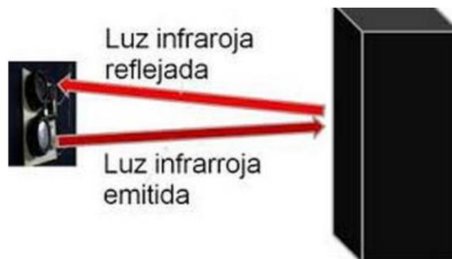
Figura 3. 22: Explicación del funcionamiento para el sensor infrarrojo.
