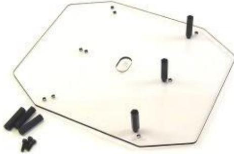
Figura 3. 10: Incorporación de los separadores en la tapa del chasis del robot sumo.
