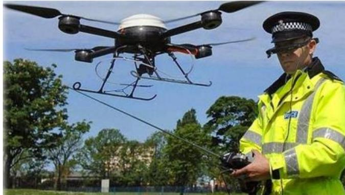
Figura 2. 31: Robot volador o dron cuya aplicación es video-vigilancia.
