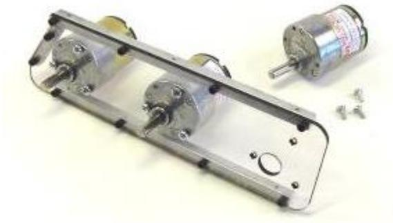
Figura 3. 7: Instalación de 3 motores en el panel lateral izquierdo del chasis para el robot sumo.
