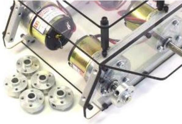
Figura 3. 13: Incorporación de los concentradores en los ejes de los motores.
