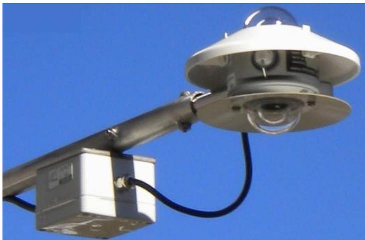
*Figura 5.2: Modelo de una albedómetro (AB20/K)
