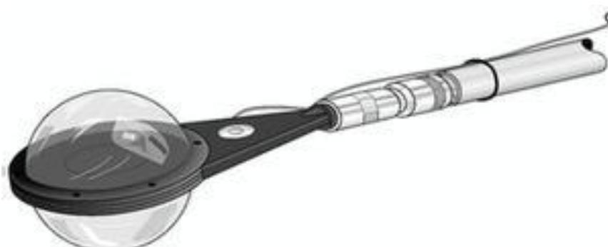
*Figura 5.6: Módulo del pirradiómetro
