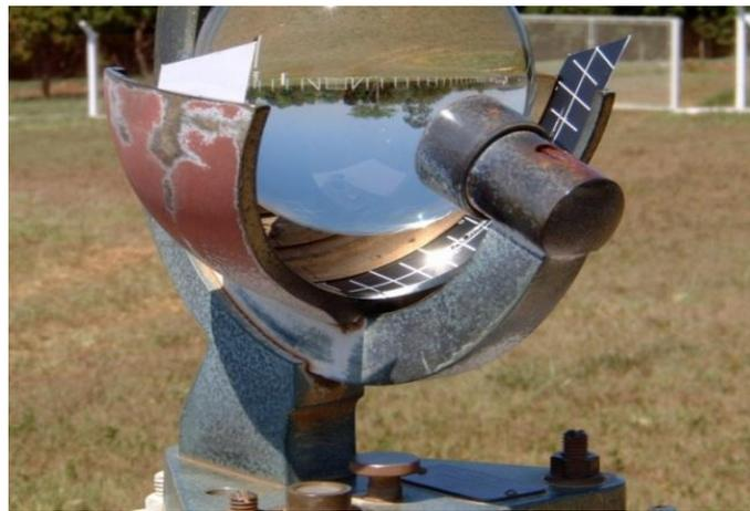
*Figura 5.8: Medición de la radiación solar
