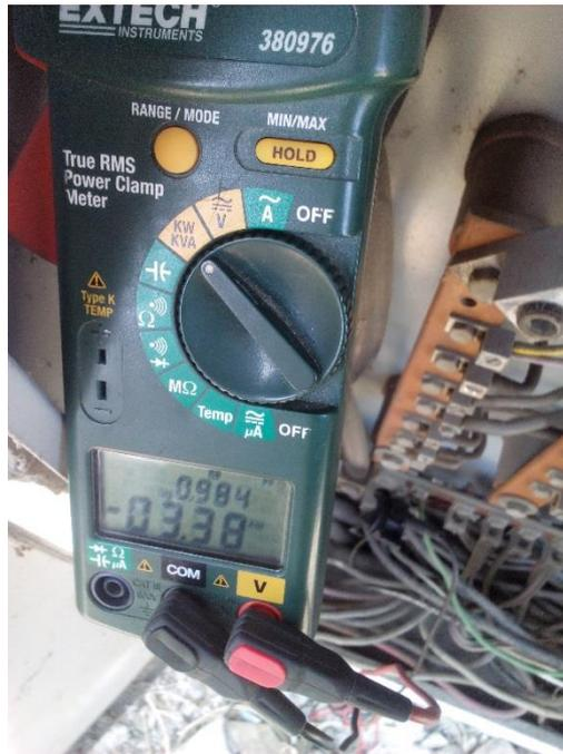
Figura 40. Medición del Factor de Potencia Fase T. Fuente: Autor
