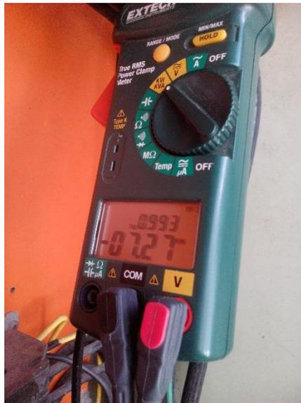
Figura 43. Medición del Factor de Potencia Fase T. Fuente: Autor
