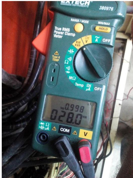
Figura 41. Medición del Factor de Potencia Fase S. Fuente: Autor
