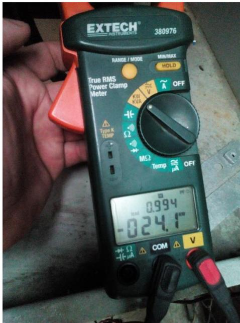
Figura 48. Medición del Factor de Potencia Fase R. Fuente: Autor
