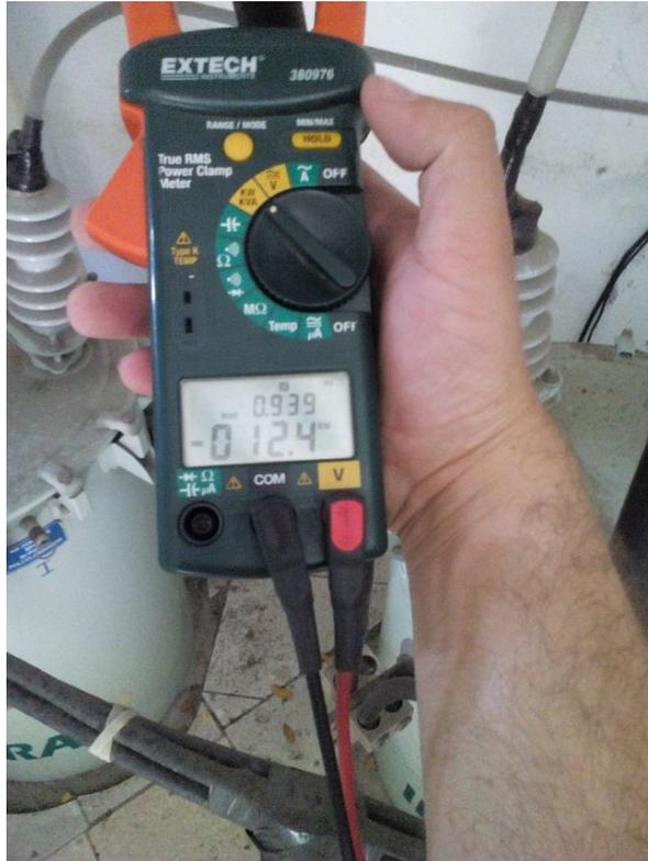
Figura 36. Medición del Factor de Potencia Fase R. Fuente: Autor
