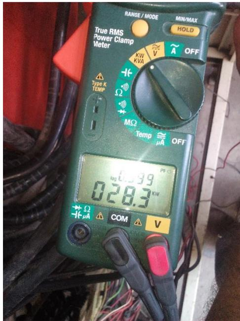
Figura 47. Medición del Factor de Potencia Fase R. Fuente: Autor
