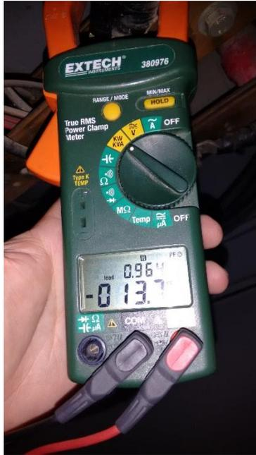
Figura 42. Medición del Factor de Potencia Fase R. Fuente: Autor
