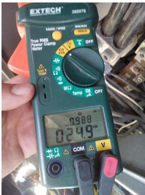
Figura 46. Medición del Factor de Potencia Fase T. Fuente: Autor
