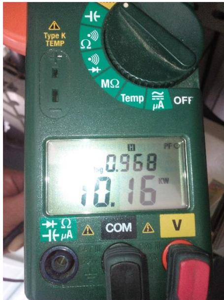
Figura 45. Medición del Factor de Potencia Fase S. Fuente: Autor
