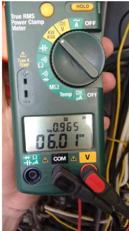
Figura 50. Medición del Factor de Potencia Fase S. Fuente: Autor
