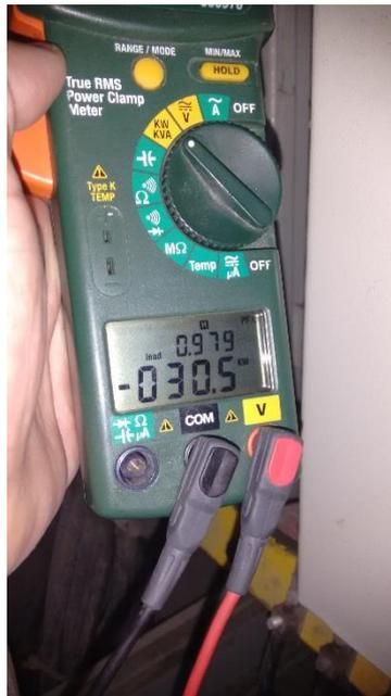
Figura 37. Medición del Factor de Potencia Fase T. Fuente: Autor
