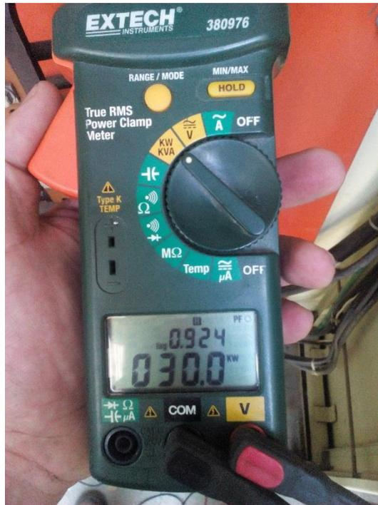
Figura 49. Medición del Factor de Potencia Fase S. Fuente: Autor
