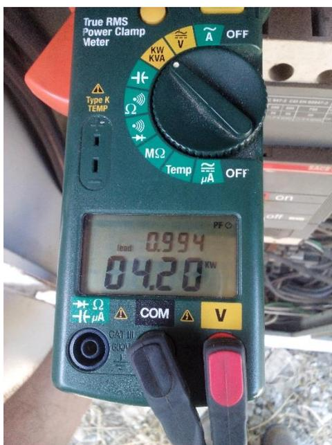
Figura 38. Medición del Factor de Potencia Fase R. Fuente: Autor
