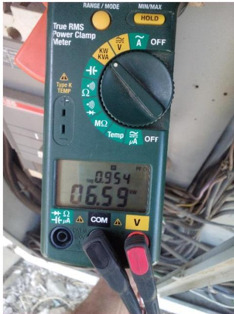
Figura 39. Medición del Factor de Potencia Fase R. Fuente: Autor
