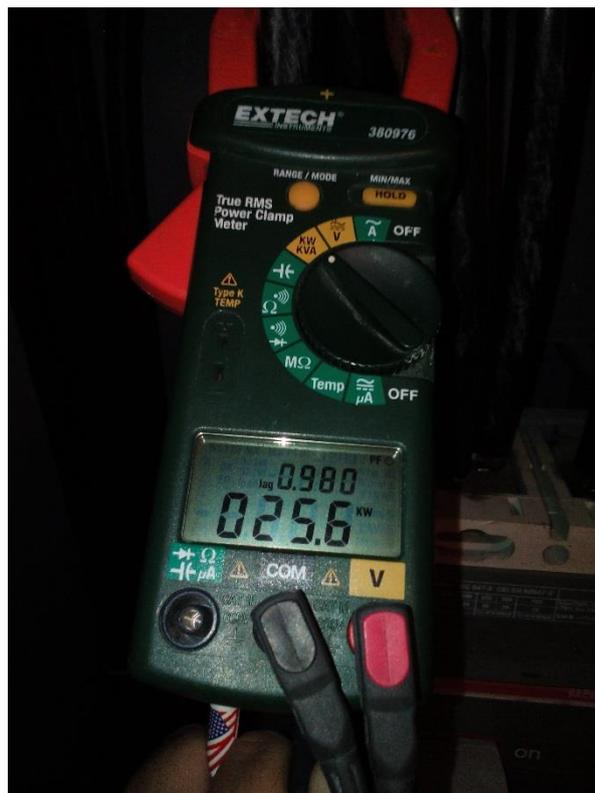
Figura 35. Medición del Factor de Potencia Fase R. Fuente: Autor
