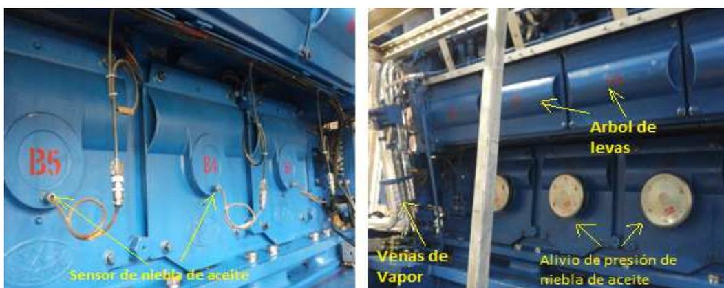
Figura 2. 13 Partes de motores de combustión interna
