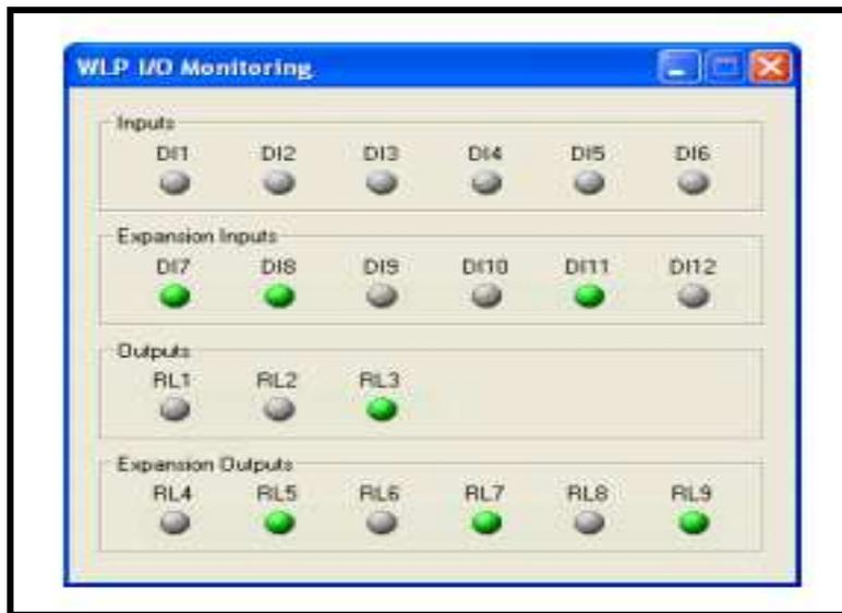
Fig. 2.24 Monitoreo de las entradas y salidas digitales
