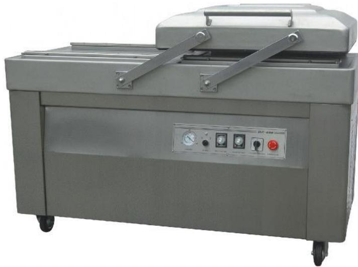
**Fig. 38 Doble Cámara de Vacío DZ-510/2SB**
