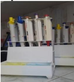
Son instrumentos de medida de volumen preciso, pueden ser fijas o variables, existen de diferentes volúmenes, a ellas se insertan manualmente puntas desechables para absorber la muestra. Pipetas aforadas miden un volumen exacto.
