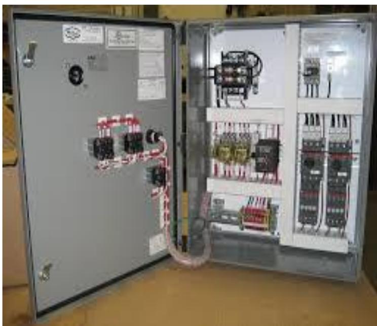
*Figura: 2.23:(panel de control de mando para motores)*
