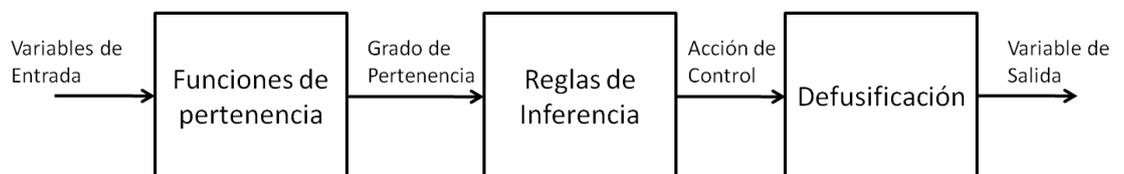
Figura 3.3: Esquema estructural del diseño del controlador.
