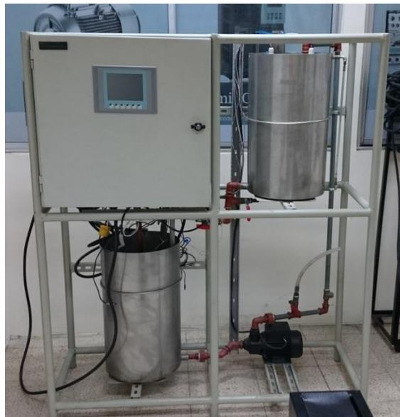
Figura 3.1: Planta de nivel seleccionada para las pruebas del controlador difuso.
