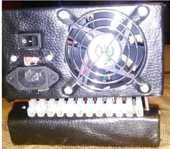
Figura 4.30: Entradas y salidas físicas del módulo de control.
