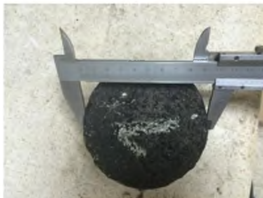
Ilustración 21: Medición de diámetro y espesor
