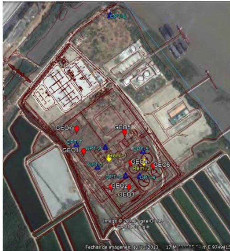
**Figura. 62.** Campaña de exploración geotécnica (PTAR EXCLUSAS)
