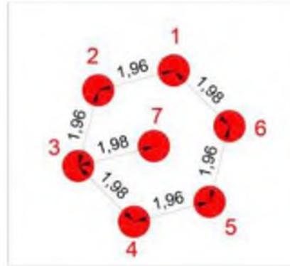
**Figura. 37** Esquema del arreglo de pilas de agregado apisonado RAP IMPACT de prueba instaladas.
