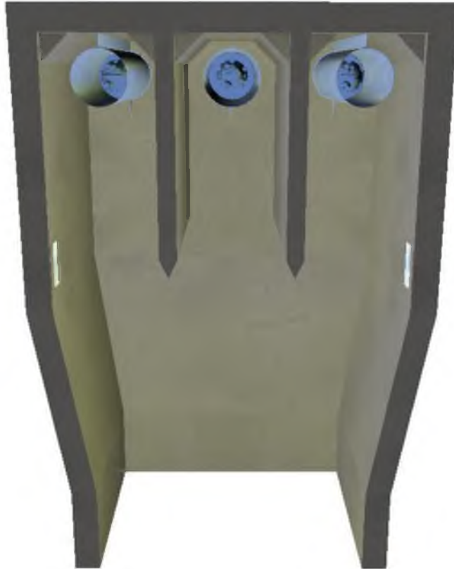
Gráfico 26: Bombas con tubería de impulsión (perfil 3D)
