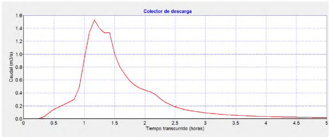
Gráfico 20: Hidrograma, colector de descarga subsistema 2, periodo de retorno 5 años
