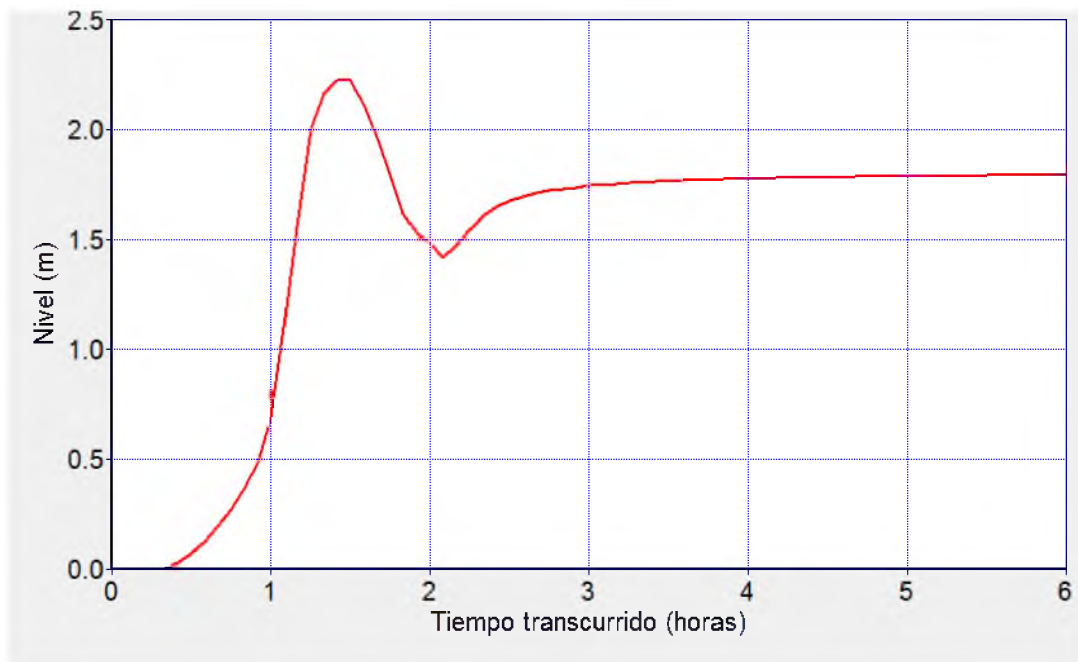
Gráfico 49: Altura de agua en el pozo de bombeo, subsistema 3, periodo de recurrencia 10 años
