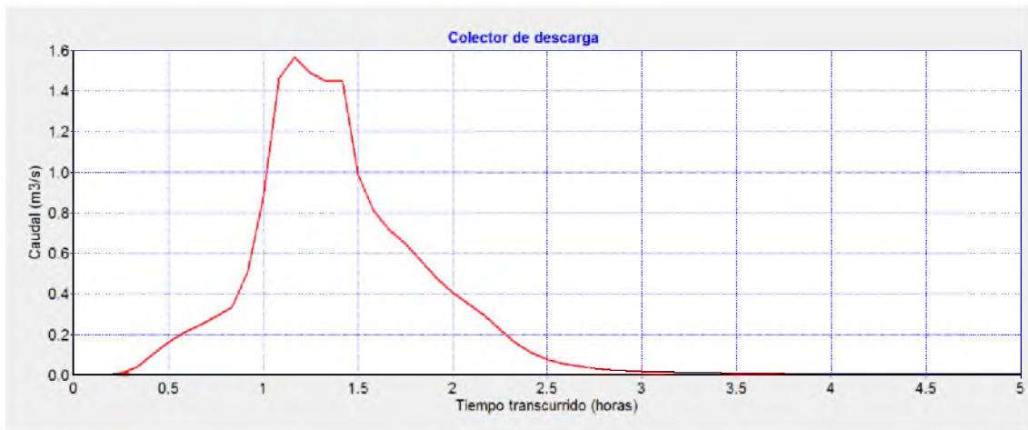
Gráfico 22: Hidrograma, colector de descarga subsistema 3, periodo de retorno 5 años
