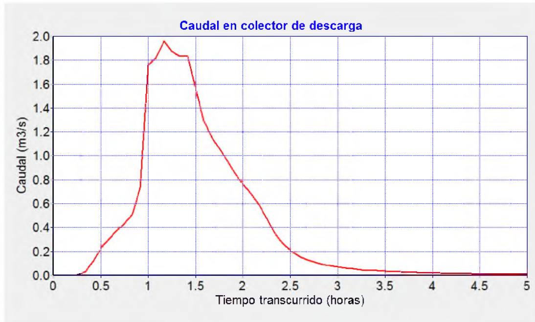
Gráfico 18: Hidrograma, colector de descarga subsistema 1, periodo de retorno 5 años
