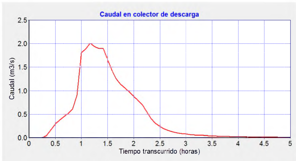
Gráfico 19: Hidrograma, colector de descarga subsistema 1, periodo de retorno 10 años
