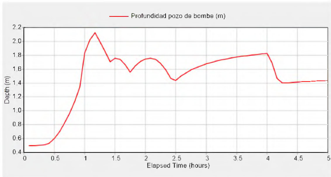
Gráfico 31: Profundidad de agua en el pozo de bombeo
