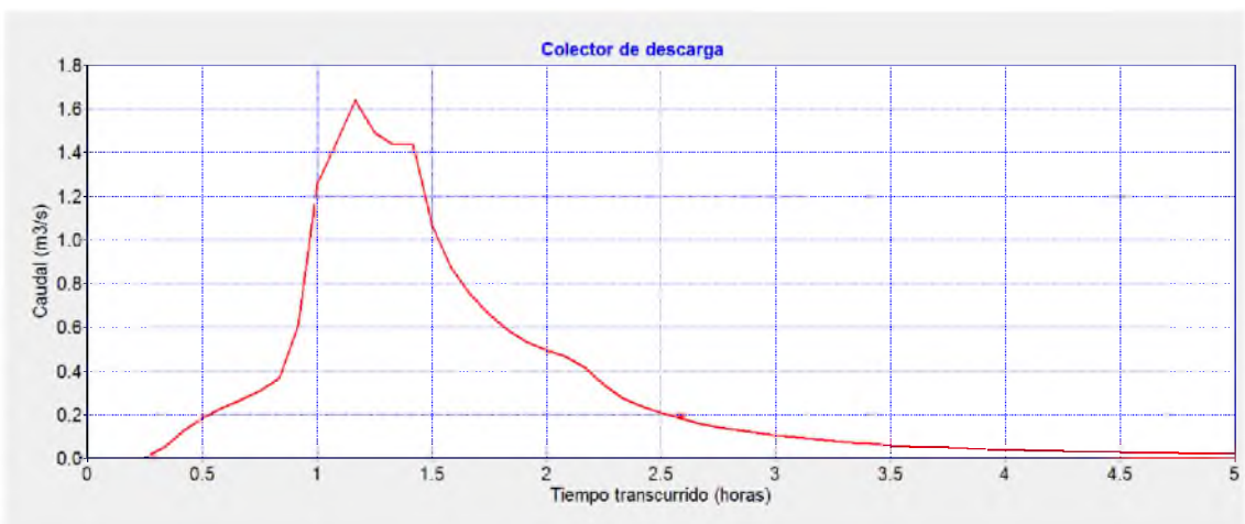
Gráfico 21: Hidrograma, colector de descarga subsistema 2, periodo de retorno 10 años
