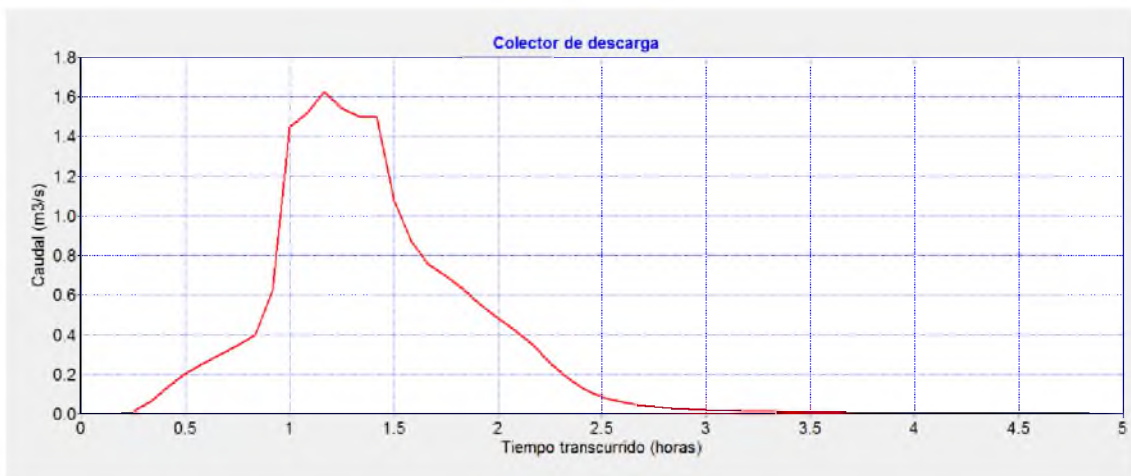
Gráfico 23: Hidrograma, colector de descarga subsistema 3, periodo de retorno 10 años
