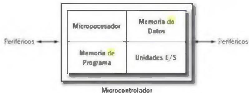
Figura 2. 1: Sistema basado en microcontroladores.
