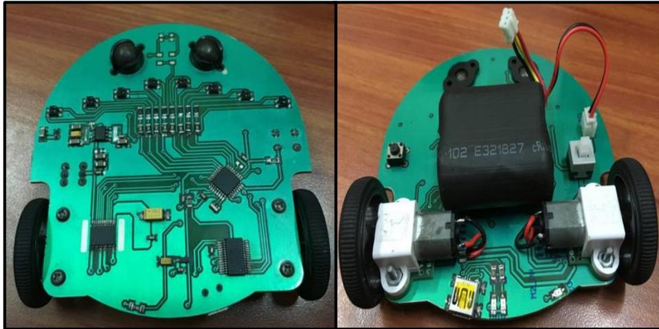
Figura 3. 33: Seguidor de línea modalidad “Velocista”
