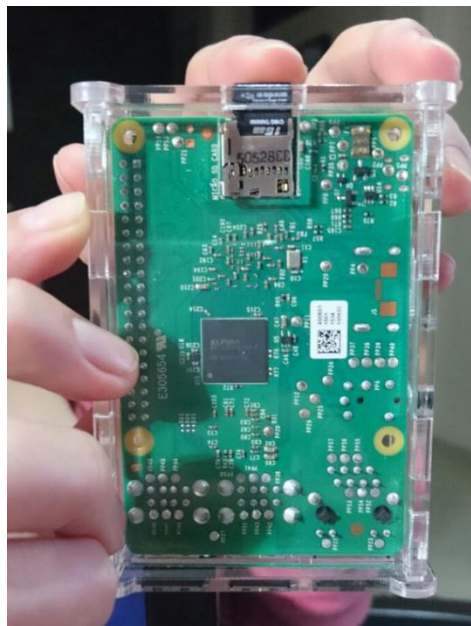
Figura 3. 18: Insertando la Micro SD en la Raspberry Pi Elaborado por: Vicente Gordon y Josselin Molina.
