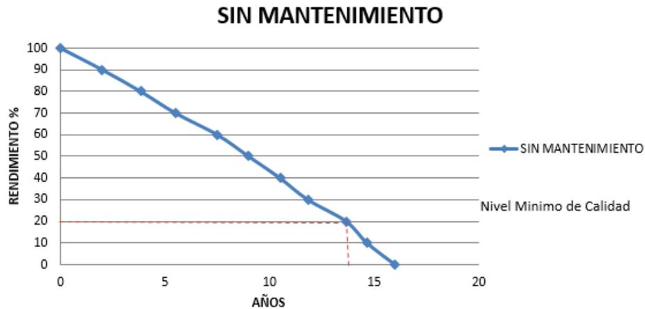
**Fig. 24. Degradación de la Piedra Natural- Sin mantenimiento**
