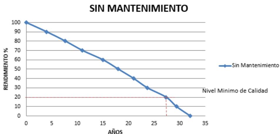
**Fig. 16. Degradación de la Piedra Natural- Sin mantenimiento**
