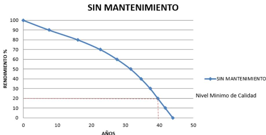
**Fig. 20. Degradación del mortero de cemento- Sin mantenimiento**
