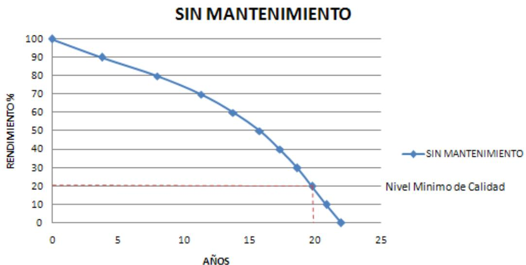
**Fig. 28. Degradación del mortero de cemento- Sin mantenimiento**
