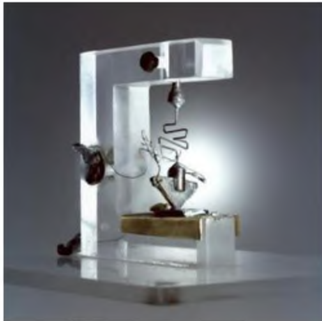
Figura 2. 2: Transistor que revolucionó las computadoras. Fuente: (Nieto, 2015)
