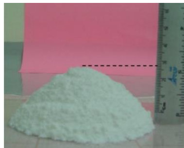
Medición del diámetro y la altura del cono formado
