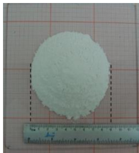
Medición del diámetro y la altura del cono formado
