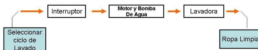
Figura 1. 3: Diagrama control Lazo Abierto
