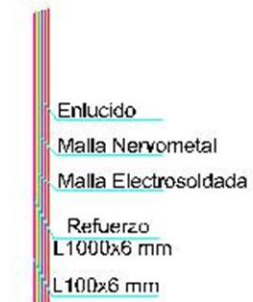
estructura de base de columna ESCALA: SIN
