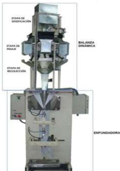
Fuente: Tesis implementación del sistema de dosificación y control de pesaje dinámico.
